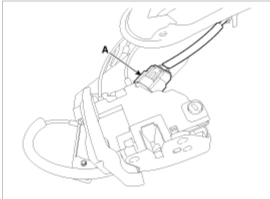
3. 拆卸后车门内侧手柄保持架 (A)。
