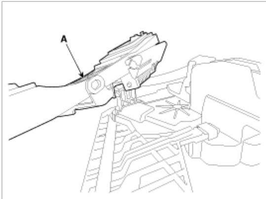
6. 拆卸后车门外侧手柄拉线(A)。
