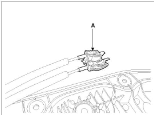
4. 向后推动并拆卸后车门内侧手柄拉线 (A)。
