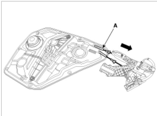
5. 推进位于背部的锁销，拆卸后车门外侧手柄基座 (A)。
